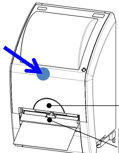
フロントカバーを下方におろし、フロントカバーの丸印付近を斜め上方よりカチッと音がするまで押して確実に閉めてください。（開閉用取手とフロントカバーの面が同じ高さになります）。
