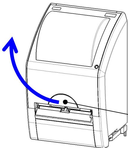
前方の開閉用取手の下部に指を掛け前方に引き出すようにフロントカバーを上方にあげてください。
