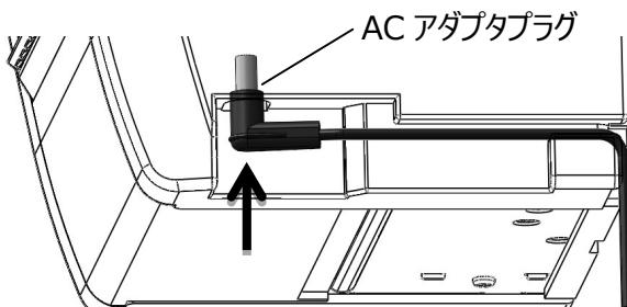
AC アダプタのプラグを本体コネクタ(本体右下)に差し込み、AC アダプタケーブルを本体と壁との間を通し配線します。
