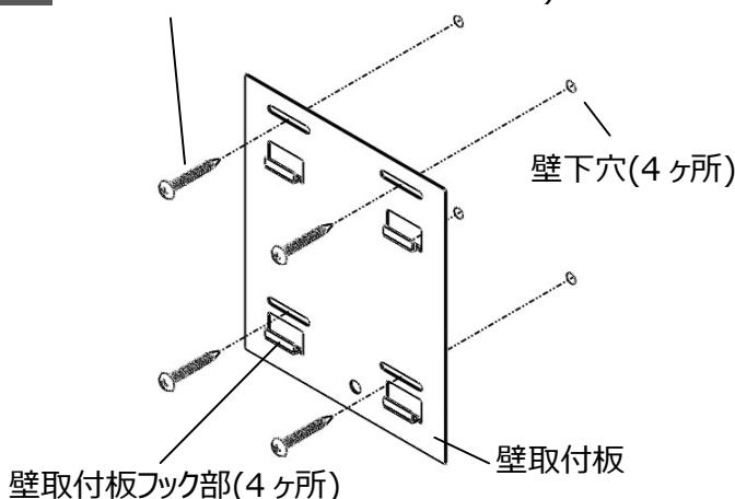
下穴をあけ壁取付板を壁取付ねじ(推奨 : トラスタッピングねじ 4x35)4 本で固定してください。
