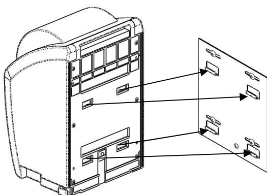
本体裏面の穴(4ヶ所)を壁取付板のフック部に合わせ、本体を壁側に押込み下に移動し固定してください。
