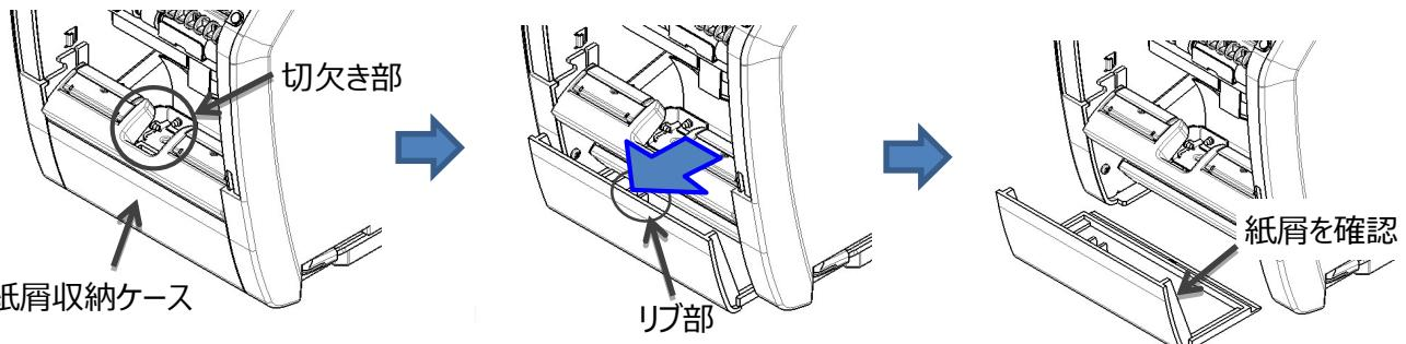
4. 紙屑収納ケースの下面両サイドの段差部を本体両サイドのケースガイド部に乗せ、スライドさせながら奥まで押し込んでください。押込み後、紙屑収納ケースと本体ケースに段差がないことを確認してください。
